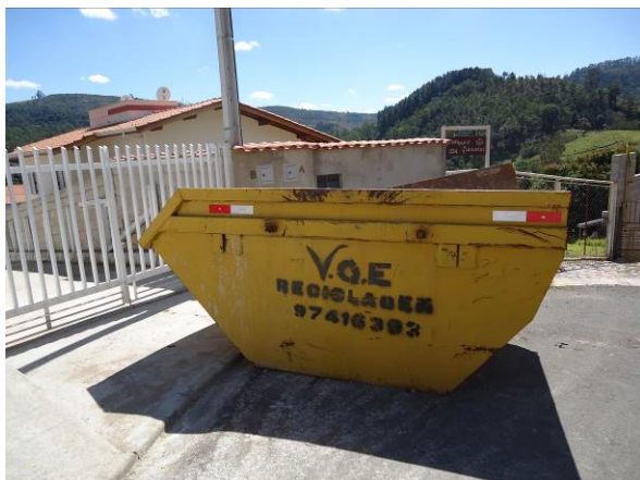
Figura 245. Caçamba de coleta de resíduos da construção civil
