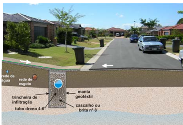
Figura 297. Sistema de drenagem superficial e infiltração na calçada – WSUD
