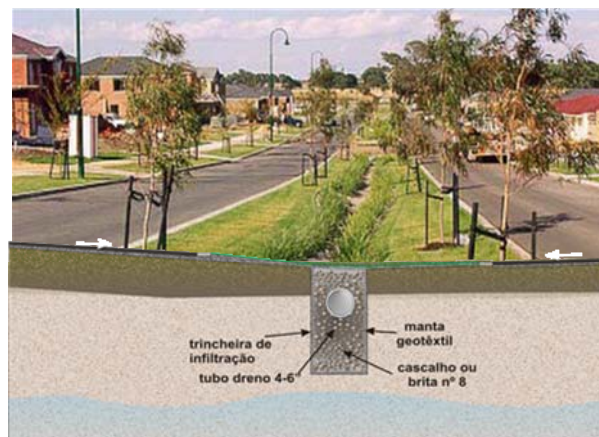
Figura 296. Trincheira de infiltração em canteiro central – WSUD
