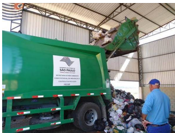
Figura 269. Caminhão compactador sendo descarregado
